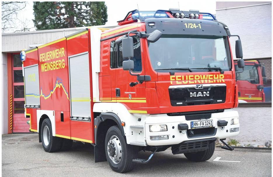
warneinrichtung auf dem Dach ist das TLF 4000 auch als Absicherungseinheit bei technischen Hilfeleistungen einsetzbar. Das 18 Tonnen Fahrgestell von MAN bildet die Grundlage für den von der Firma Lentner gefertigten Aufbau und der von der Firma Ziegler gelieferten Ausrüstung.
