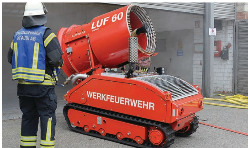
LUF 60 Compact beim Entrauchen einer Halle.
