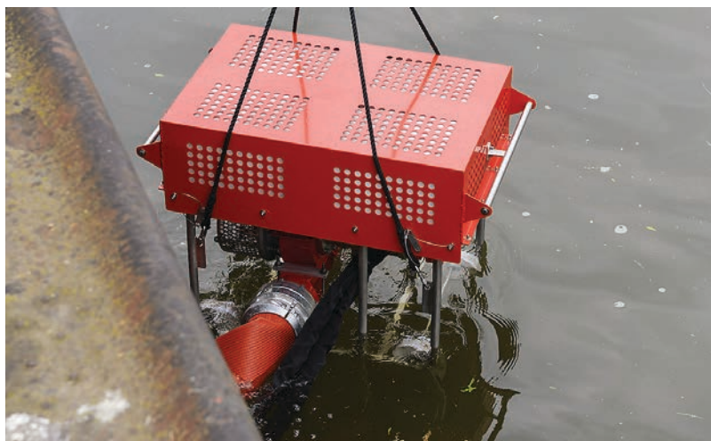
Hydraulische Schwimmpumpe, betrieben von LUF 60.
