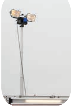
Fahrzeuglichtmast mit 2 x 1.500-W-Halogen-scheinwerfern zum Ausleuchten der Einsatzstelle
