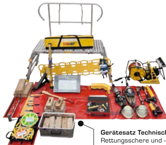
Gerätesatz Technische Hilfeleistung I Wagenheber, Tauchpumpe, Motorsägen, Trennschleifer, Abschleppseile, Kaminreiniger, Flaschenzug, Wassersauger, div. Werkzeug; bei Unwetter und kleinen Unfällen
