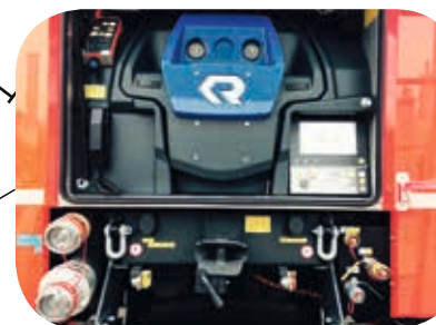
ROSENBAUER Feuerlöschkreiselpumpe mit Schaumzumischanlage
