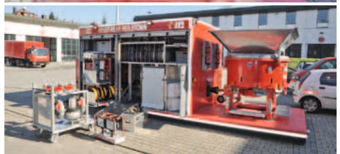
Oben und Mitte: Die Sandsackfüllmaschine „Power Sandking 800“ mit feuerwehrtechnischer Zusatzbeladung.
