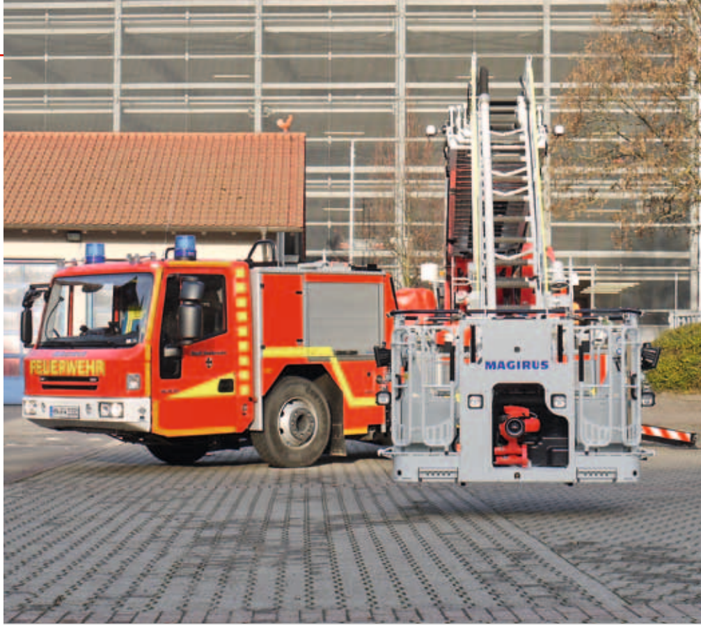
4-Mann-Rettungskorb mit integriertem Wasserwerfer.
