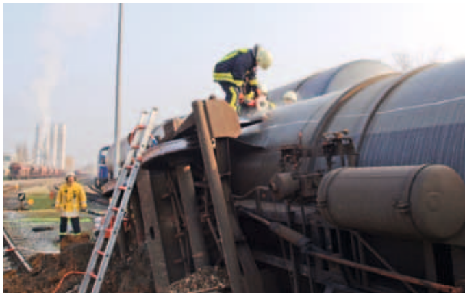
Funkenfreies Arbeiten mit Hilfe einer gegenläufigen Spezialsäge.
