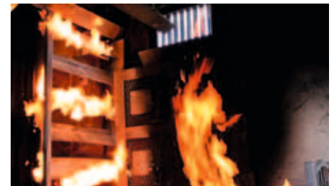
Im Brandcontainer steht ein (gasbefeuetes) Bett in Flammen.
