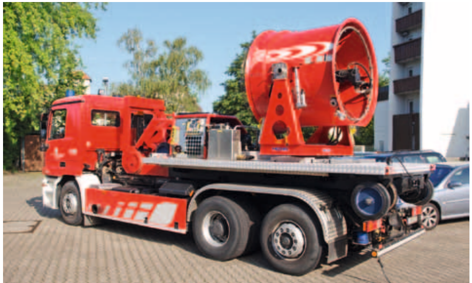
Der Großventilator auf einem der Wechselladerfahrzeuge.
