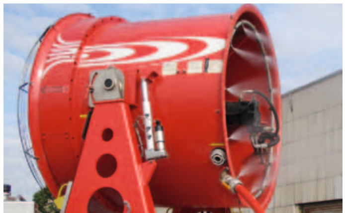
Herstellung von feinem Wassernebel.
