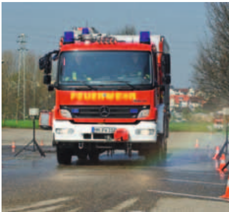
Bremstests: Ein modernes Hilfeleistungslöschfahrzeug auf der nassen Schleuderpiste. Das Antiblockiersystem ABS vermittelt dabei mehr Sicherheit.
