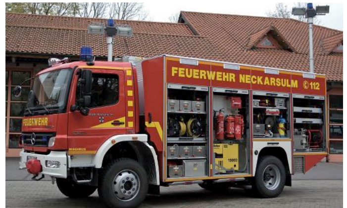
Der RW der FF Neckarsulm verfügt über zwei Lichtmasten. Ein Lichtmast ist vorn, der andere hinten am Aufbau montiert
