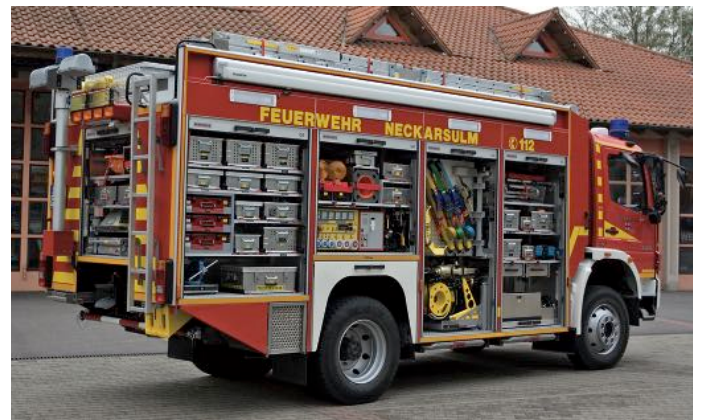
Auf der rechten Fahrzeugseite befindet sich eine Markise. Der zentrale Bedienstand für den Stromerzeuger, die Lichtmasten und die Markise befindet sich im Geräteraum G6
